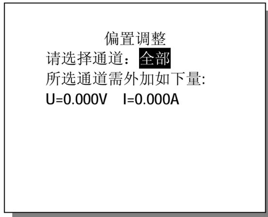
按【确认】键确认，如果成功将弹出窗口偏置校验成功，否则弹出偏置校验失败。
