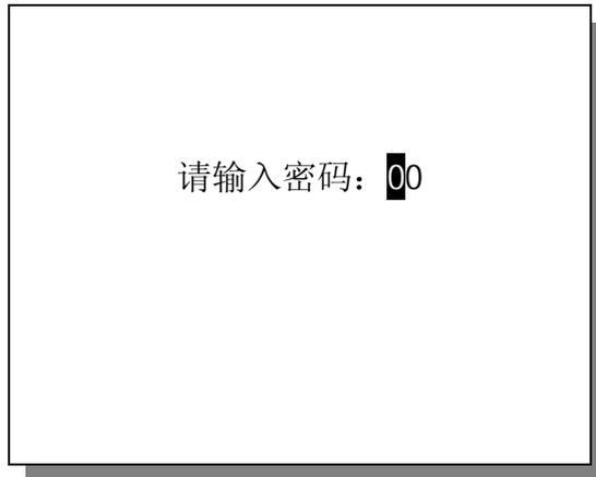
用“<”键、“>”键选择输入位置，用“+”键和“-”键输入密码，按【确认】键进入。若密码错误，显示密码错误消息框：
